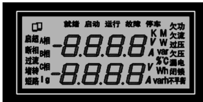
显示部分采用段码液晶，液晶背光为白色。背光时间可以由用户设定，有按键操作时，背光被重新点亮，并于设定时间后熄灭。
