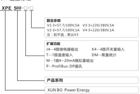
示例：XPE-500-J4K4T-V3：额定380V/5A，4路开关量，4路继电器输出输入，1路温度输入，谐波测量功能，多功能仪表。
