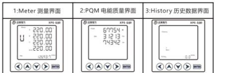
在“Meter”功能显示项，按 键或 键可以轮流显示实时测量数据，如图所示
