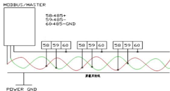
**MODBUS** 协议只允许在主机（PC，PLC 等）和终端设备之间通讯，而不支持独立的终端设备之间的数据交换，这样各终端设备不会在它们初始化时占据通讯线路，而仅限于响应到达本机的查询信号。
