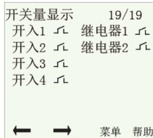
上图所示为开关量的状态显示。其中左半部分为开关量输入状态；右半部分为开关量输出状态。对于开关量输出的状态表示，根据菜单设置，可有 8 种不同的输出方式。
