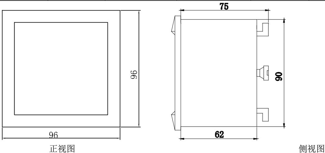
图 2.1.1.1 96 型机械尺寸图 (单位: mm)
